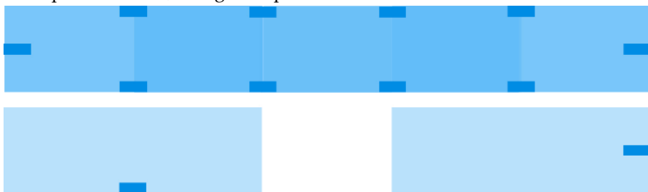
Imagen 66: Arriba – toberas de cobertura rectangular, disposición en franja. Abajo – coberturas individuales de los emisores empleados
