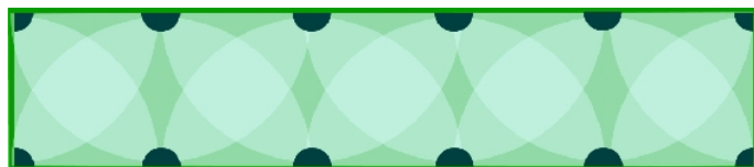
Imagen 65: Toberas de cobertura estándar – disposición en franja
